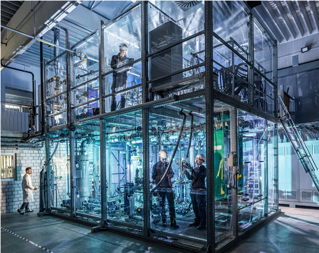
Abbildung 1: Shortstack-Testfeld am EST mit erweiter- ter Messtechnik und Kompressionseinheit.
