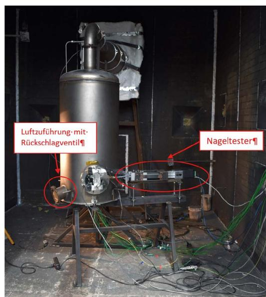
Abbildung 4: Messhaube mit Anpassungen an der Luftführung. Hier dargestelltes Setup für Nagelpenetration.
