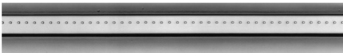
Abbildung 7: Funktionalisierter Polymerwellenleiter mit integrierter Bragg-Gitter-Sensorstruktur.
