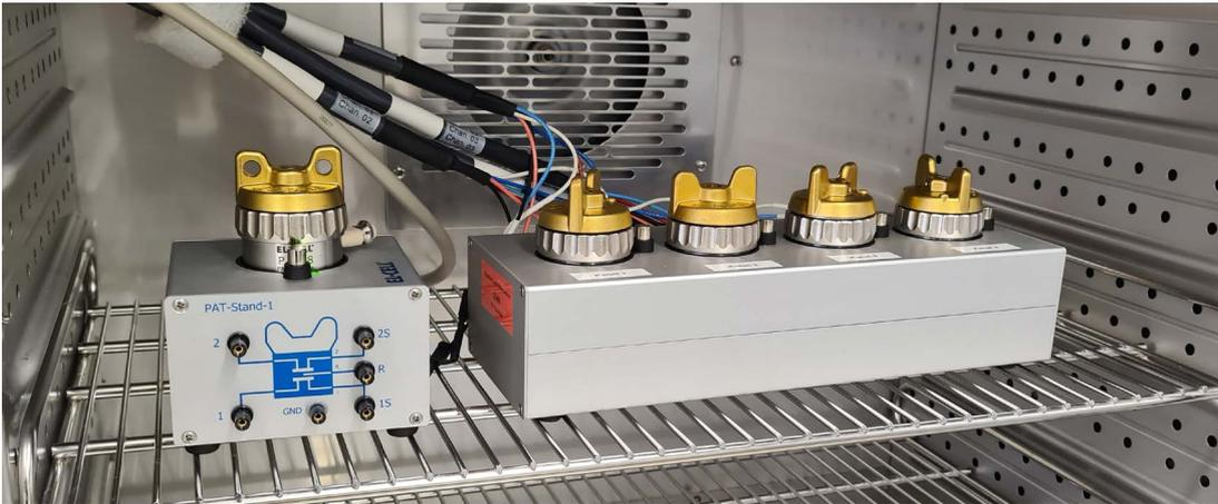
Abbildung 2: Laborzellen (El-Cell©) zur elektrochemischen Charakterisierung von Batteriematerialien unter Beachtung der Halbzellpotentiale.
