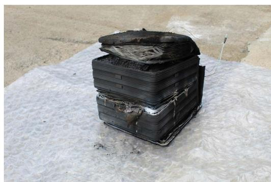
Abbildung 3: Modul ohne Brandschutzlagen (links) mit Brandschutzlagen (rechts) nach Abuse-Test mit Initialisierung durch das gezielte Überladen einer Zelle im mittleren Bi-Pack.
