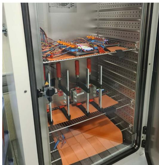
Abbildung 3: Lebensdauer- und Performanceuntersuchungen von 18650-Rundzellen (oben) und verspannten prismatischen Zellen (Zellen) in einem Temperierschrank mit erhöhten Sicherheitsanforderungen.
