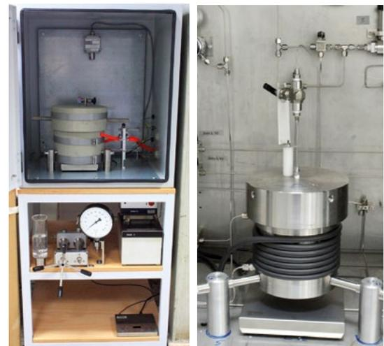
Abbildung 4: Prototyp des HPHT-Autoklavs in der explosionsgeschützten Ausführung für Wasserstoffanwendungen (H<sub>2</sub>STORE Projekt) und Aufbau einer neuen HPHT-Zelle
