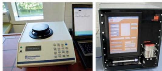
Abbildung 3: Gaspycnometer AccuPyc 1340 für die Bestimmung der Porosität von Gesteinsprobekörpern unter Laborbedingungen (links) und Gaspermeameter SYROPERM für die Bestimmung der Permeabilität der Probekörper unter Laborbedingungen (rechts)
