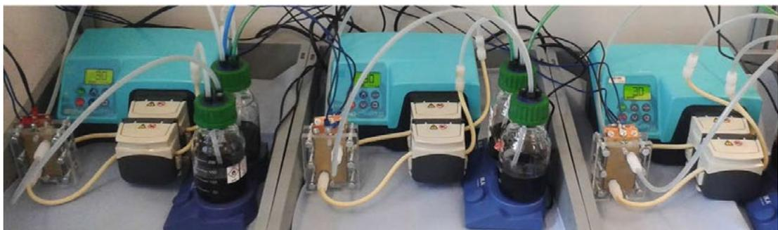
Abbildung 4: Parallelisierte Materialuntersuchungen mit Einzelzellen mit 10 cm<sup>2</sup> akt. Fläche
